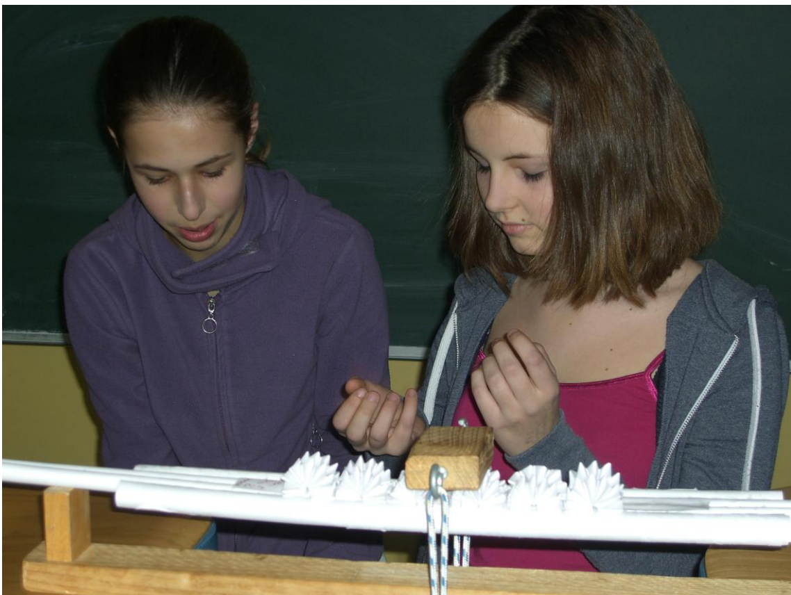
4. Platz mit einer Röhrenkonstruktion und einer Belastungsverteilung. Die Brücke hat eine Tragkraft von 7,9 kg, (Vanessa, Ayla).
