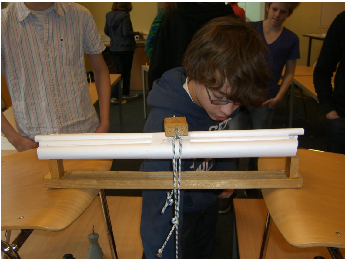
3. Platz mit einer mehrfach Röhrenkonstruktion und einer Belastbarkeit von 8,5 kg (Joshua, Malte).
