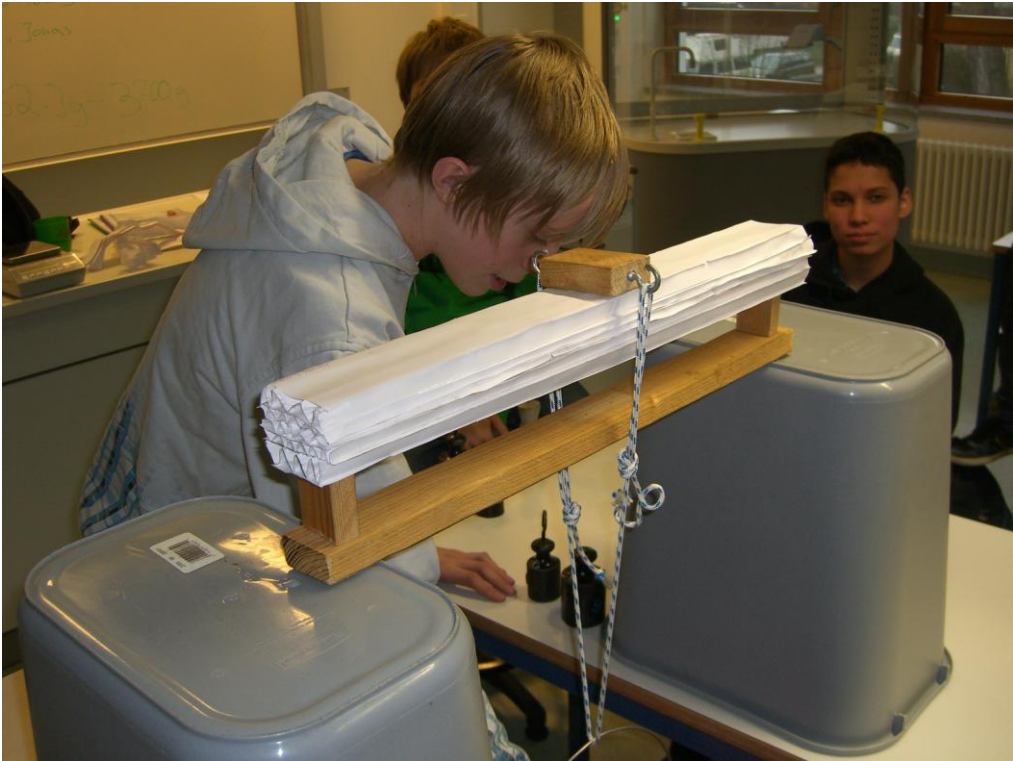
Die Siegerbrücke,: Mehrlagige Dreieckskonstruktion, Belastbarkeit 9,26 kg (Marco, Sammy)
