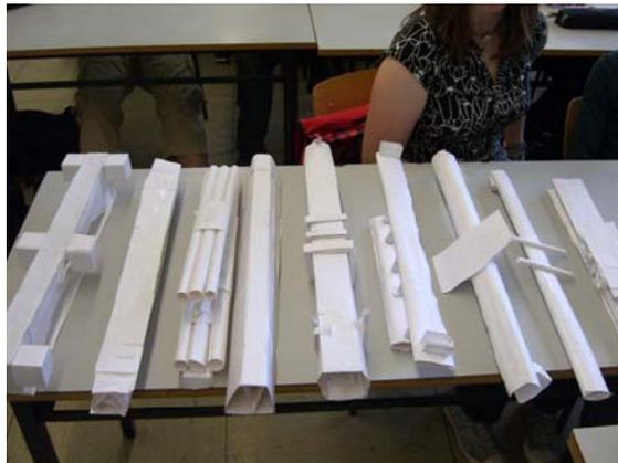
Die Siegerbrücke: Einfache Röhrenkonstruktion, Belastbarkeit 8,9 kg (Amir, Jan)
